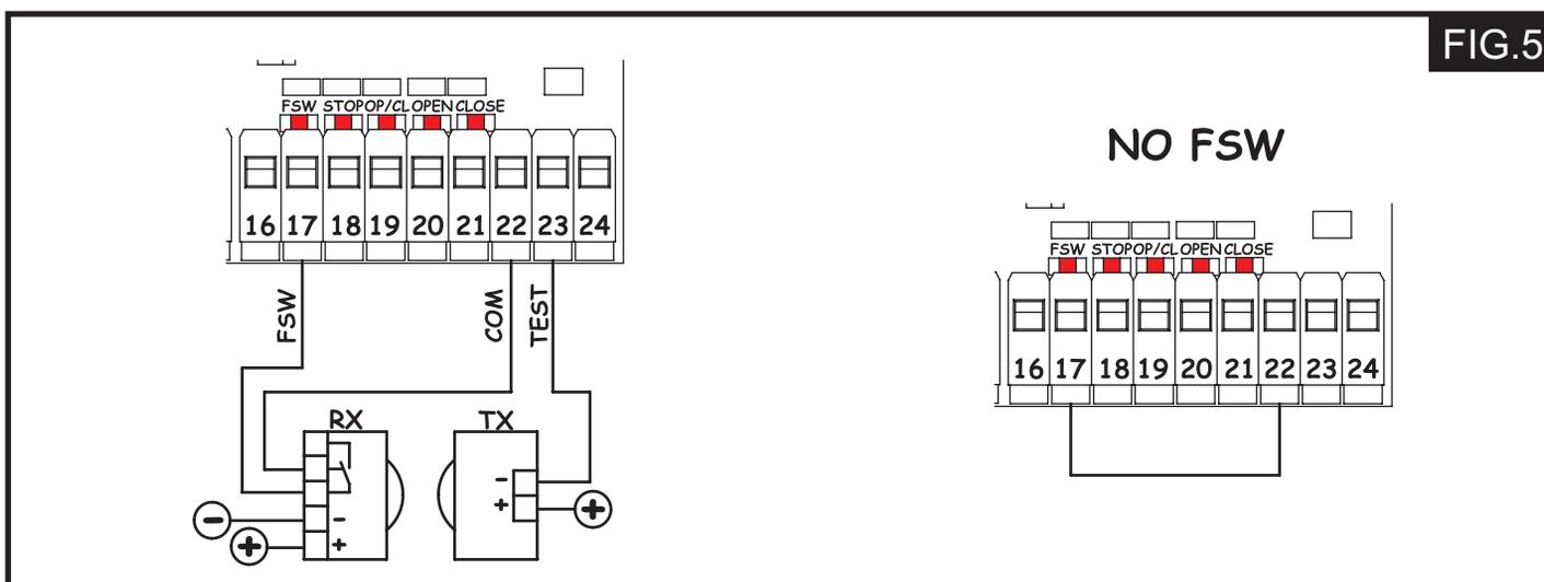
Bornes "18 y 22". Contacto NC. A este contacto hay que conectar un emisor de impulsos cualquiera (p.ej. pulsador, selector de llave) que, al abrir el contacto, mande una parada inmediata de la barrera, desactivando las posibles funciones automáticas. Después de un impulso de STOP debe enviarse un impulso de OPEN para reanudar el normal funcionamiento de la barrera. El estado de esta entrada está indicado por el diodo Led STOP.
